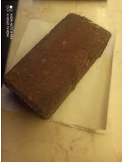
Cihla - hmotnost 2,75 kg, délka 25 cm, šířka 12 cm, výška 6 cm
