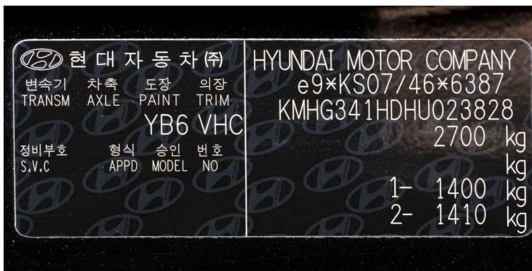
Obr. 3: Ukázka opticky variabilního prvku – logo Hyundai, které je viditelné jen pod určitým úhlem dopadajícího světla. V logu (pravá nožička písmena H) je zároveň použit ochranný prvek „mikrotext“, ve kterém je napsáno slovo „Hyundai“
