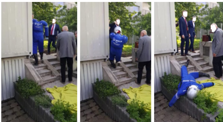
Rozběh k figuríně Strčení do hrudníku figuríny Dopad figuríny, konečná poloha Obr. 5: Fotografická dokumentace vyšetřovacího pokusu.
